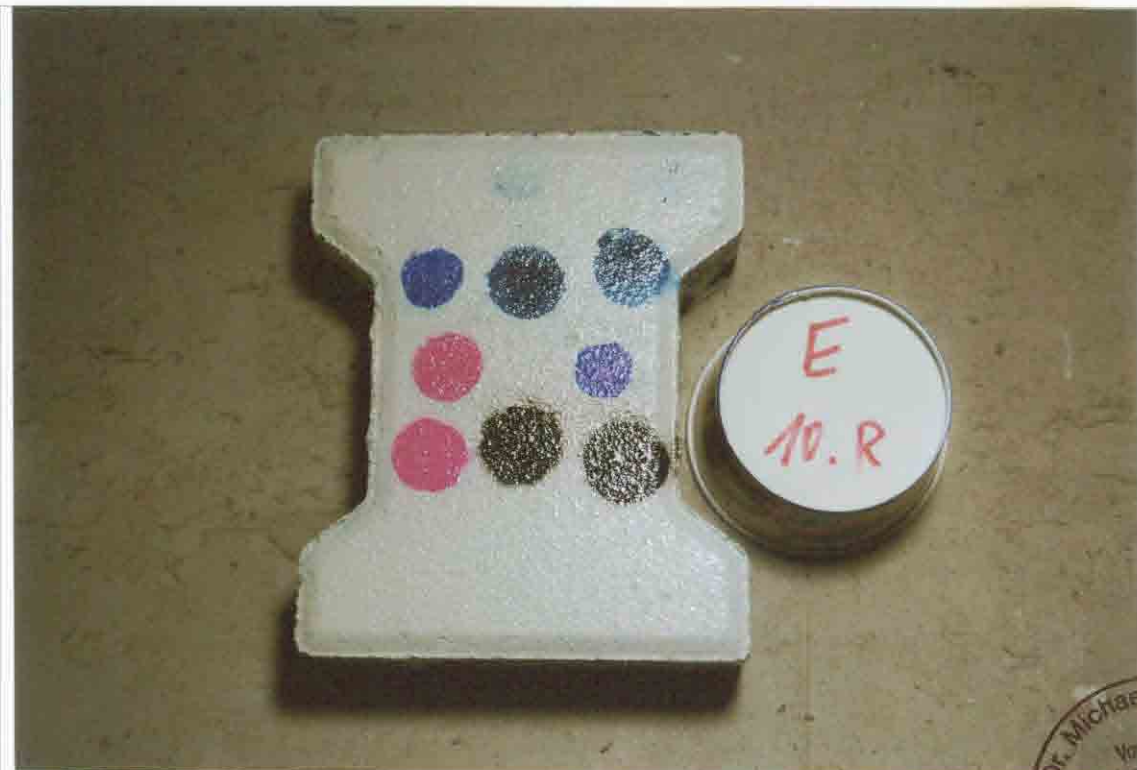
Foto 21 Betonwerkstein MA II/5 mit System C vor dem 10. Reinigungszyklus
