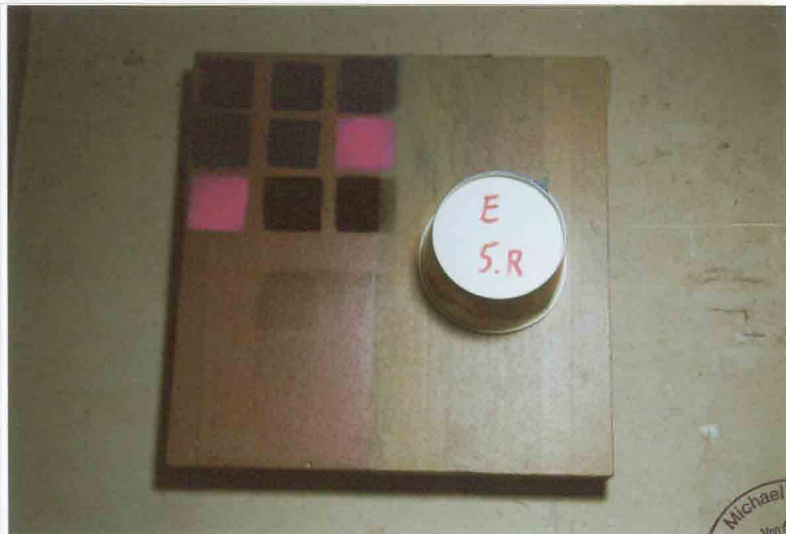
Foto 11 Roter Mainsandstein System B (5. Reinigungszyklus)
