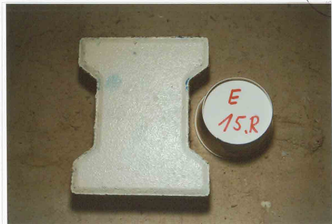
Foto 24 Betonwerkstein MA II/5 mit System C nach dem 15. Reinigungszyklus
