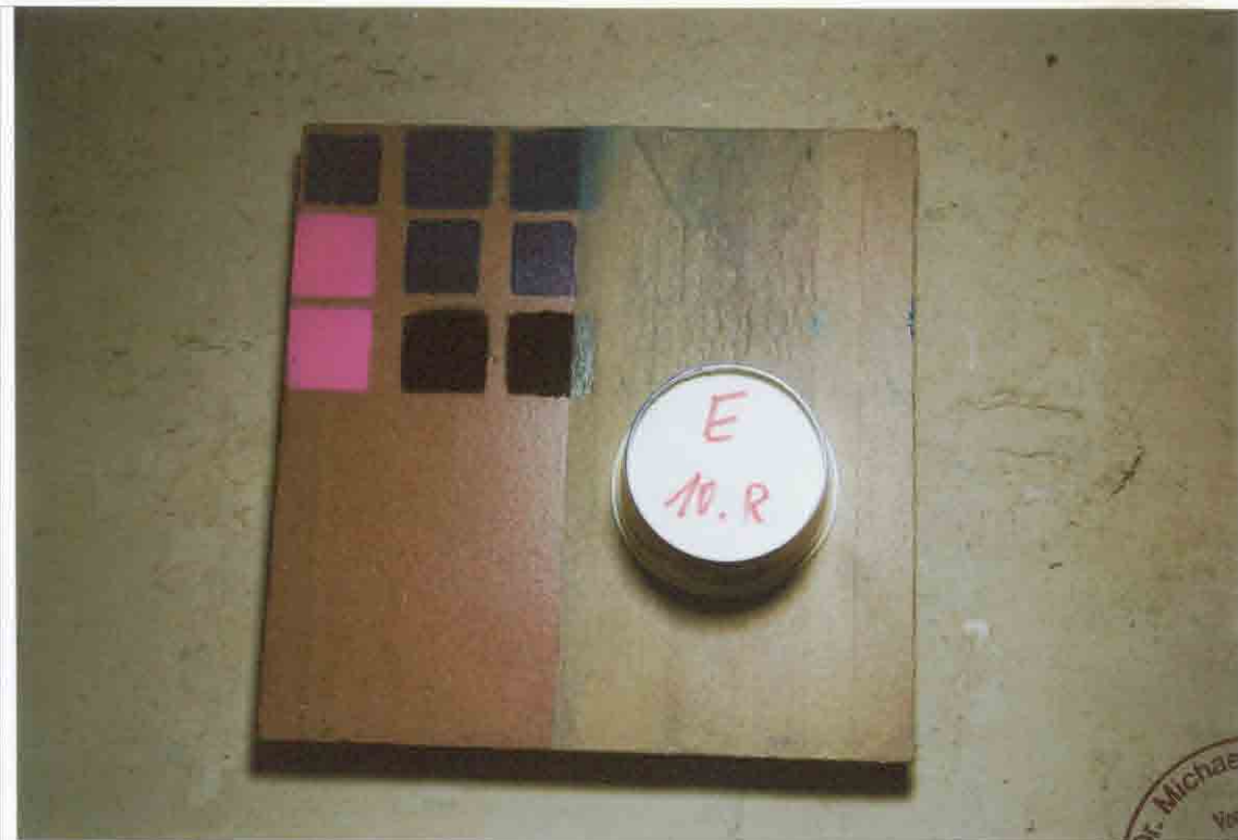
Foto 13 Roter Mainsandstein System B (10. Reinigungszyklus)
