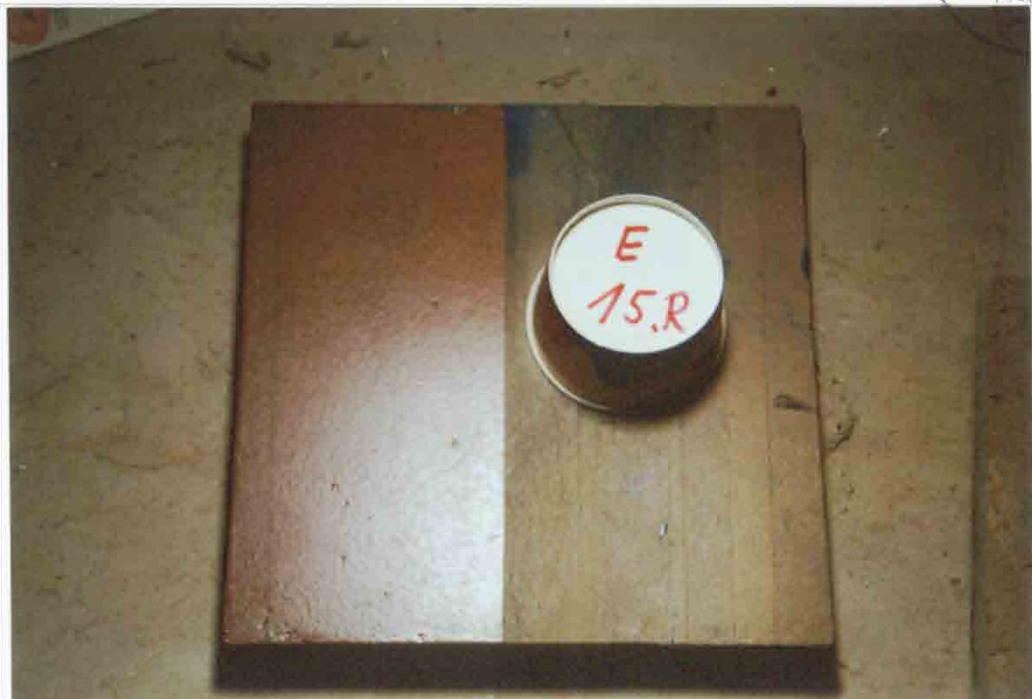
Foto 16 Roter Mainsandstein System B nach dem 15. Reinigungszyklus
