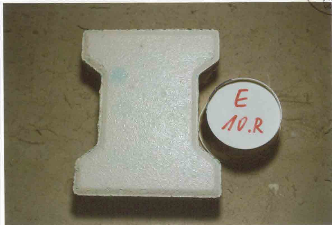
Foto 22 Betonwerkstein MA II/5 mit System C nach dem 10. Reinigungszyklus
