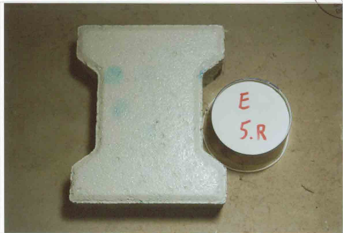
Foto 20 Betonwerkstein MA III/5 mit System C nach dem 5. Reinigungszyklus
