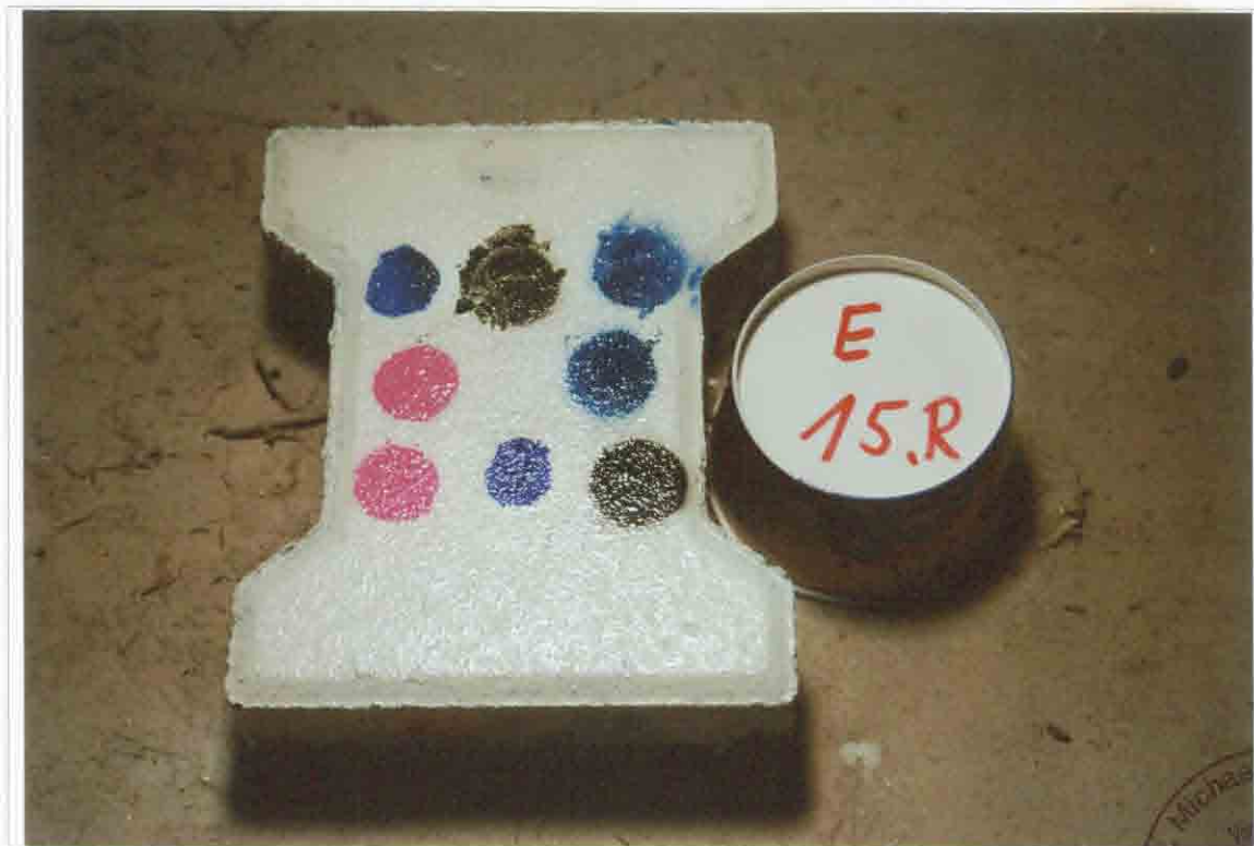
Foto 23 Betonwerkstein MA II/5 mit System C vor dem 15. Reinigungszyklus
