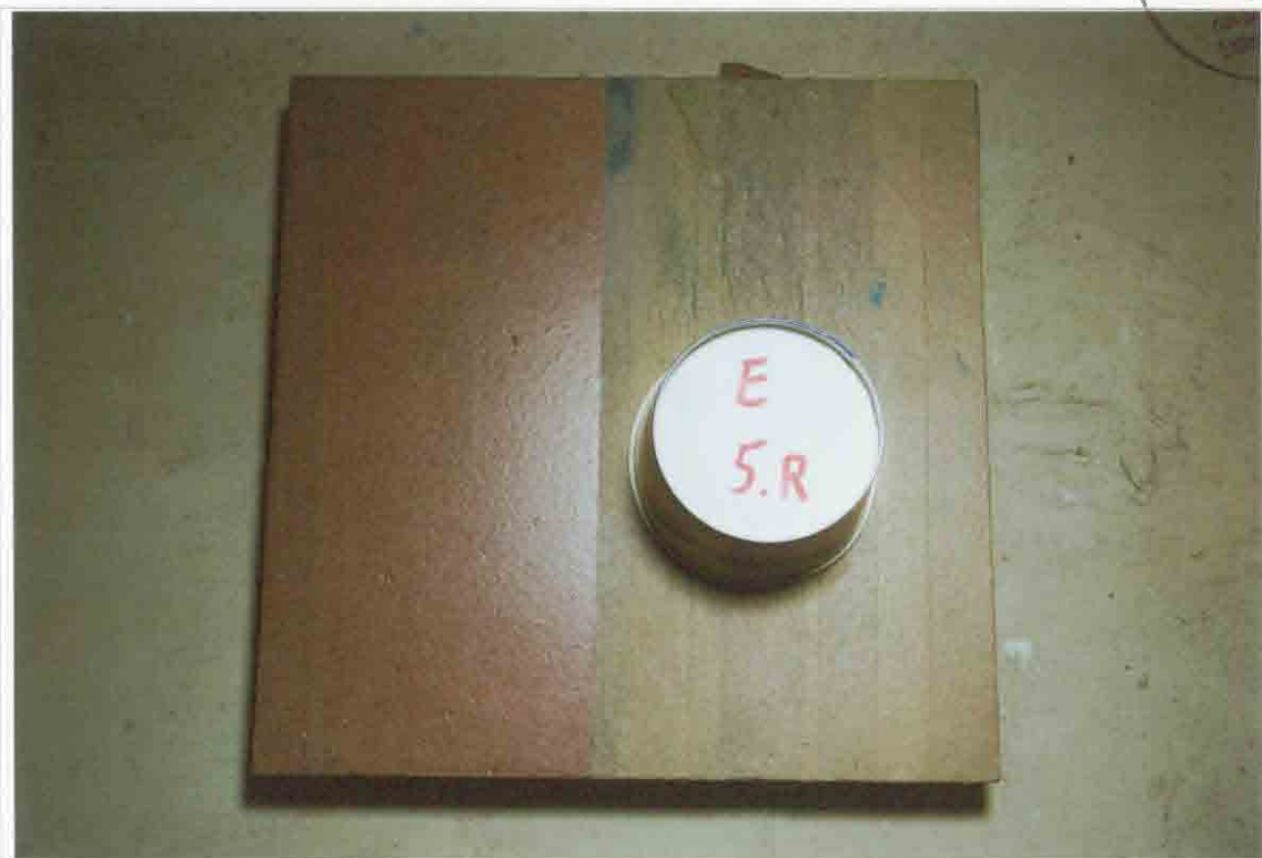
Foto 12 Roter Mainsandstein System B nach dem 5. Reinigungszyklus
