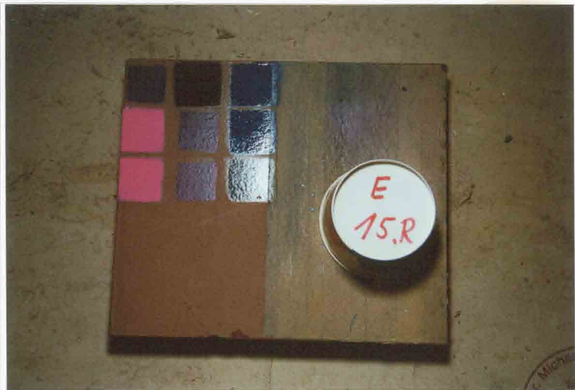
Foto 7 Roter Mainsandstein System A (15. Reinigungszyklus)
