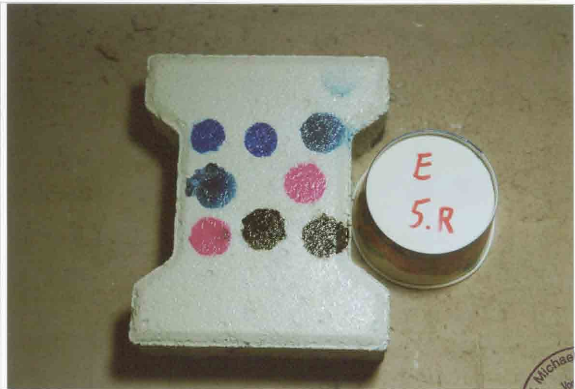
Foto 19 Betonwerkstein MA II/5 mit System C vor dem 5. Reinigungszyklus
