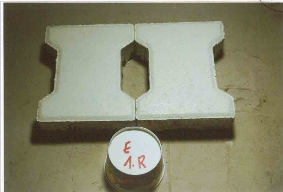
Foto 18 Betonwerkstein MA II/5 und MA II/6 mit System C nach der 1. Reinigung
