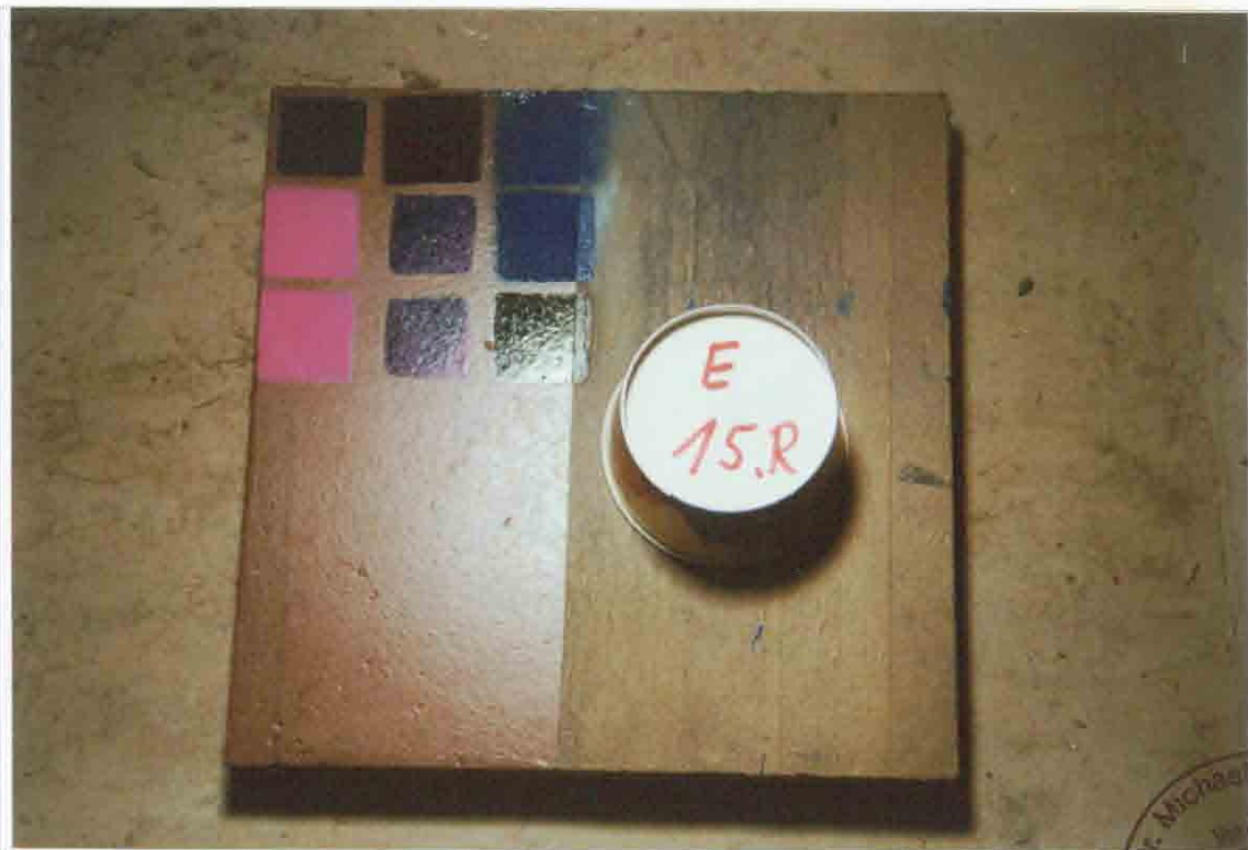
Foto 15 Roter Mainsandstein System B (15. Reinigungszyklus)
