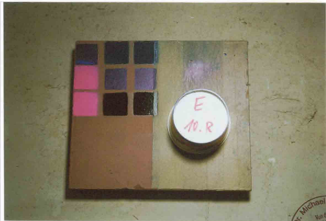
Foto 5 Roter Mainsandstein System A (10. Reinigungszyklus)
