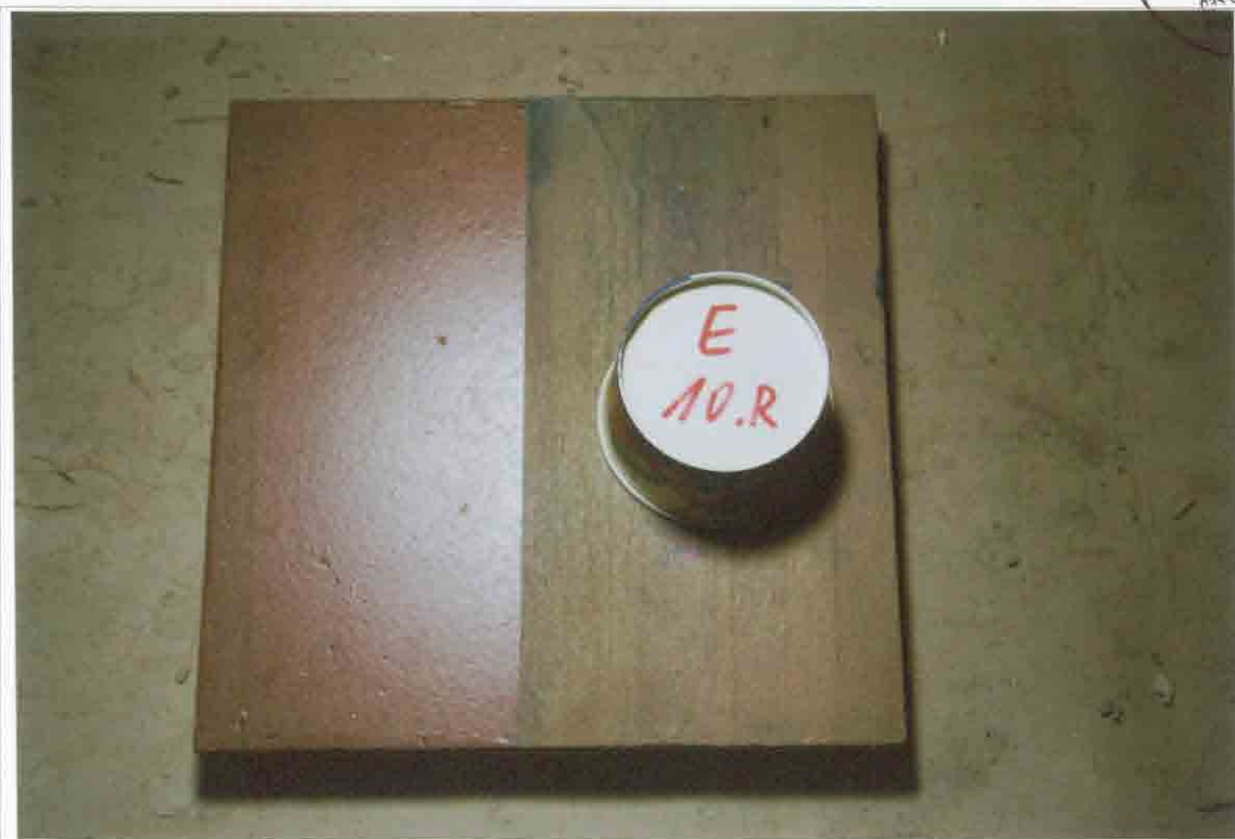
Foto 14 Roter Mainsandstein System B nach dem 10. Reinigungszyklus
