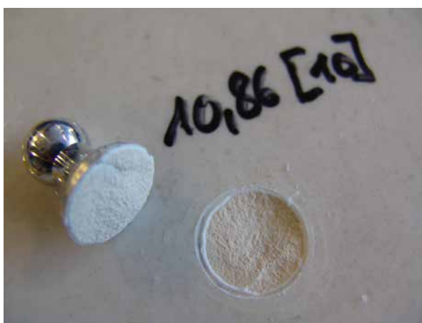
GRAFFINET® GK-Primer und GRAFFINET® Transparentlack matt auf keramischer Fliese: 11 N/mm 2 im Durchschnitt.
