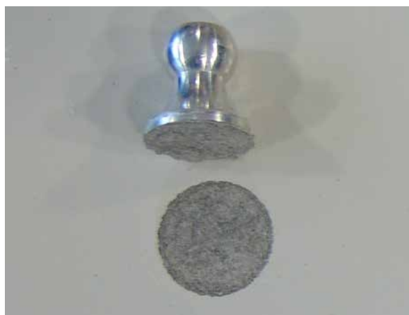
GRAFFINET® GK-Primer und GRAFFINET® Farblack seidenmatt RAL 9010 auf Faserzementplatte: 3 N/mm 2 im Durchschnitt.
