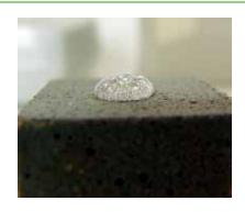
**Testreihe:** Das Beispiel oben links zeigt die Eindringtiefe nach 5 Sekunden Kontakt. Das Beispiel oben rechts zeigt den Abperleffekt auf einer mit NanoSafe® AquaStop behandelten Betonplatte.
