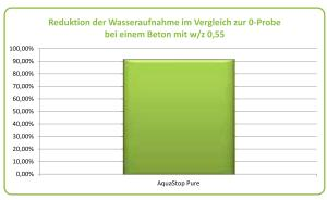
**Testreihe:** Das Produkt wurde zweimal nass in nass auf Betonprismen im Alter von 28 Tagen aufgetragen. Eine Woche später wurde anhand einer 7-tägigen 3 mm Wasserlagerung die kapillare Wasseraufnahme von unbehandeltem und behandeltem Beton untersucht. Diese Ergebnisse entsprechen dem Durchschnitt aus jeweils drei Versuchsreihen, wobei jede Versuchsreihe aus 24 Prismen besteht.
