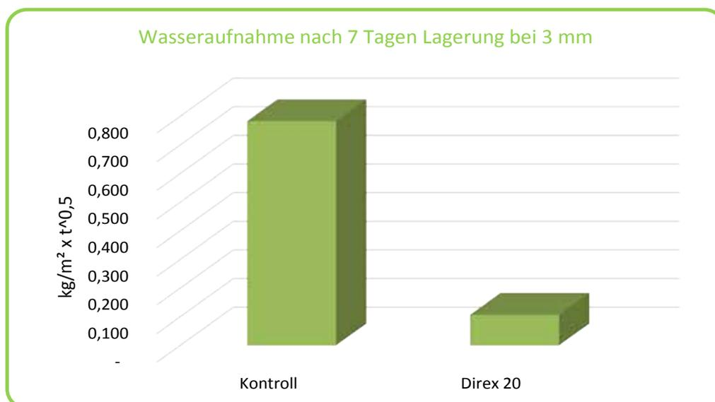
Oben stehende Graphik zeigt, dass NanoSafe® DIRex 20 die Wasseraufnahme von Beton um 86 % reduziert.
