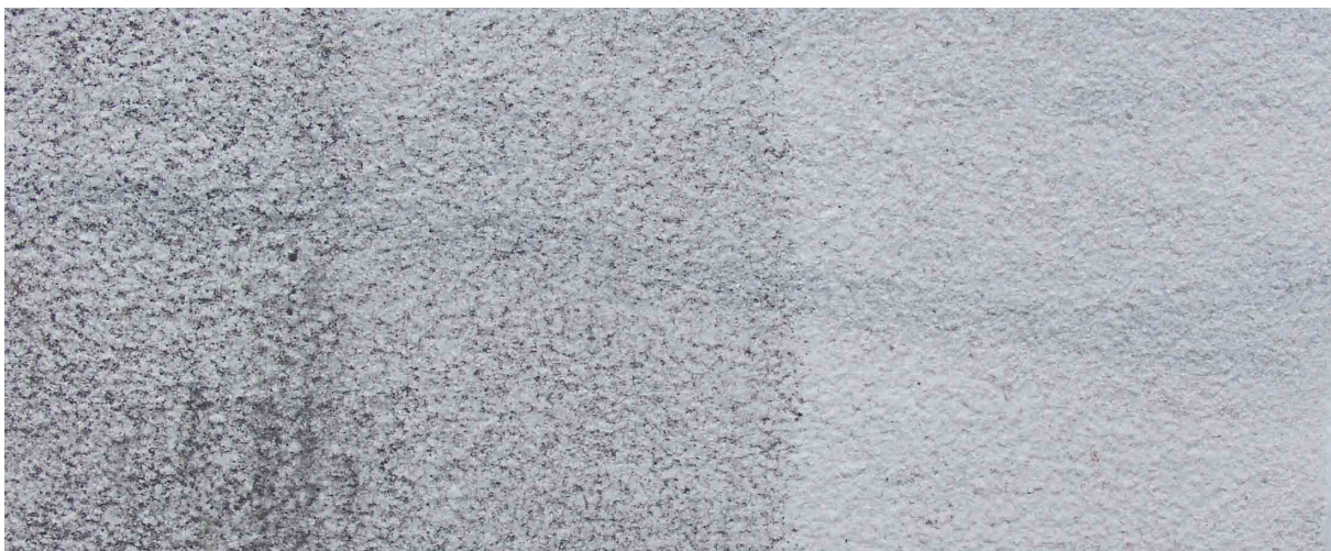
Marmorplatte: links unbehandelt, rechts mit NanoSafe® SC Konzentrat imprägniert. Nach 10 Jahren wirkt der Verschmutzungsschutz noch.
